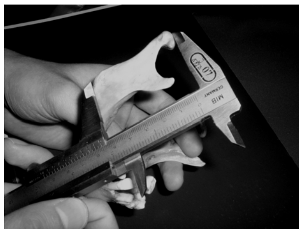
Sl. 2 – Direktno manuelno merenje kljunastim merilom sa nonijusom
